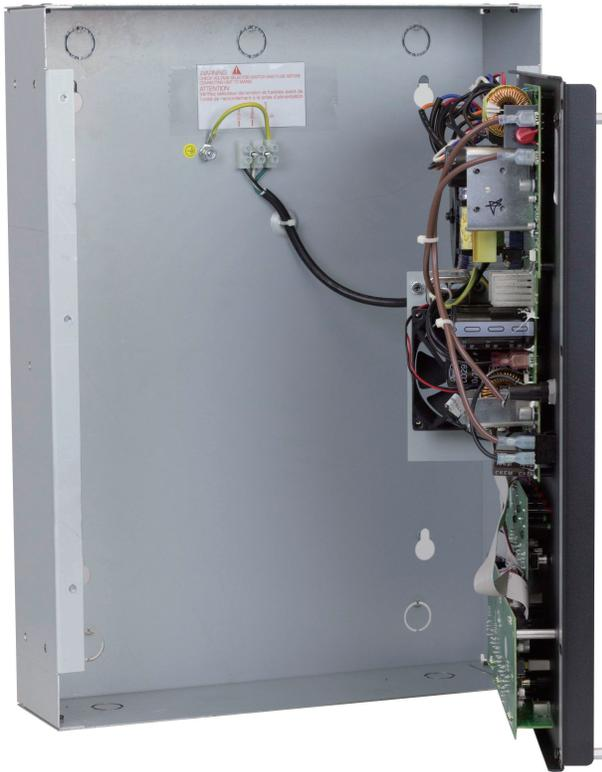
**Nota:** Para el montaje lateral en espárragos, se usa una cantidad de 8 sujetadores #10 o equivalentes, 4 en cada lado. Para el montaje trasero, se usa una cantidad de 4 sujetadores de 1/4" (6,3 mm) o equivalentes. Los sujetadores deben ser de un tipo apropiado para el material al que se fijará la unidad. La instalación deberá realizarla una persona calificada o un profesional.
