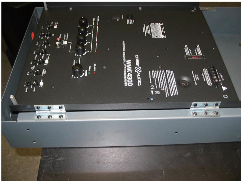
Staffa aggiunta utilizzando i fori di montaggio esistenti.
