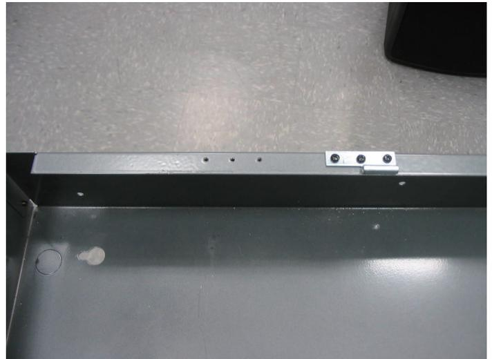
Telaio montato sulle cerniere posteriori.
