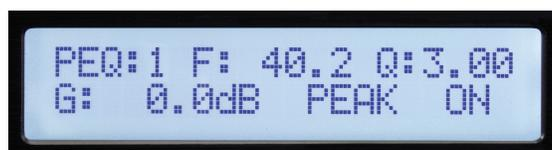
Los canales de entrada tienen 8 bandas de ecualización disponibles y los resultados tienen 9. La banda de ecualización está indicada en la esquina superior izquierda de la pantalla. (La banda 1 se muestra arriba). El parámetro seleccionado para el ajuste destellará en la pantalla. Pulse la perilla de parámetro para seleccionar un parámetro para editar. Gire la perilla para ajustar.
