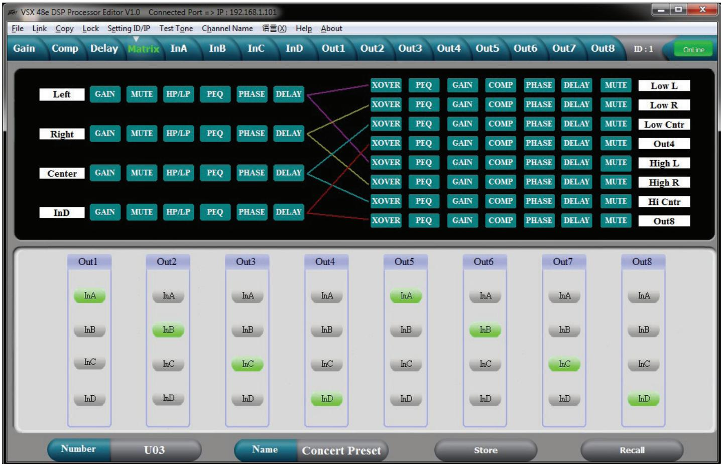
Las fuentes de entrada para cada salida se enrutan en la pantalla de Matriz. Haga clic en el botón de entrada debajo de la salida para seleccionar. Si se ha seleccionado más de una fuente, aquellas entradas se sumarán. Una representación gráfica del enrutamiento se da en la parte superior. Las entradas y salidas pueden rotularse en esta pantalla.
