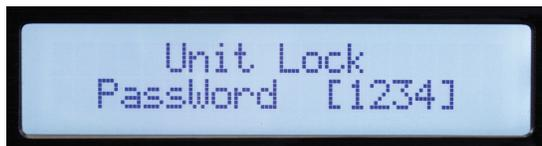
Una vez en esta pantalla, la perilla de parámetro se utiliza para establecer la contraseña. Pulse para avanzar y girar para cambiar cada dígito. Una "Y" o "N" aparecerá lo que permitirá activar el bloqueo "Y" o desactivarlo "N".
