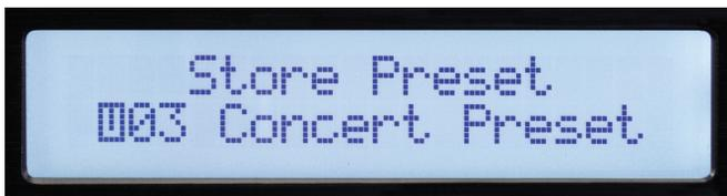
Seleccione la ubicación de almacenamiento del usuario deseada mediante el control de parámetro y luego púselo. Introduzca un nombre para el preajuste y pulse el control de parámetro de nuevo cuando aparezca la "Y" para completar la operación de guardar.
