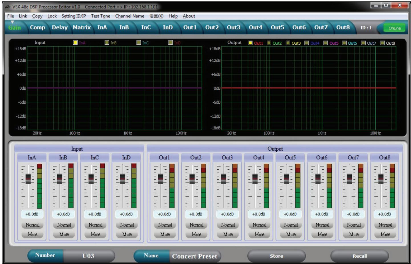
La ganancia por encima de la pantalla ofrece una buena visión general del sistema. Además de mostrar las ganancias de entrada y salida, silencio y estado de polaridad, la entrada y la salida de las curvas de ecualización puede visualizarse.
