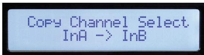
Los ajustes se pueden copiar fácilmente de un canal de entrada a otra entrada o de una salida a otro. Gire el codificador de parámetros para seleccionar el parámetro.
