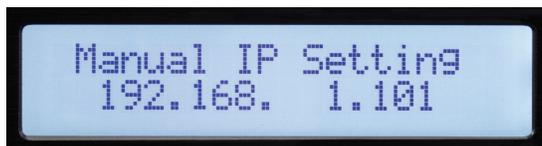
Establezca la dirección IP Ethernet aquí para la conexión al programa de edición a través del puerto Ethernet. ¡Asegúrese de anotar la nueva dirección si edita la dirección!
