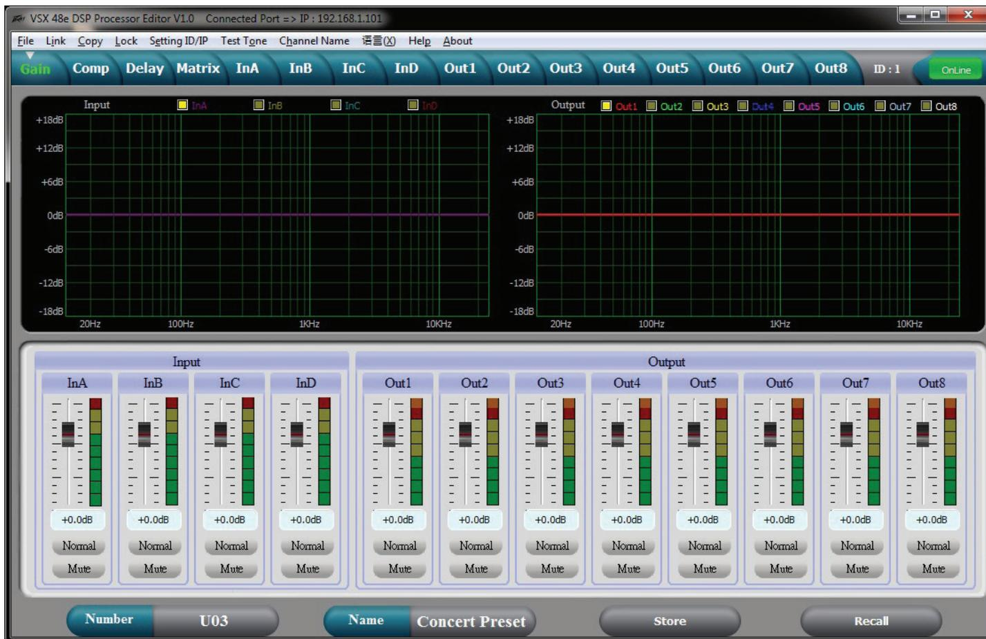
A tela de ganho acima fornece uma boa visão geral do sistema. Além de mostrar os ganhos de entrada e saída, estado de mudo e polaridade, curvas de equalização de entrada e saída podem ser exibidas.
