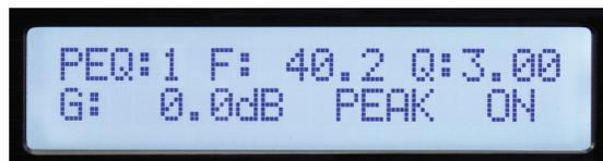
Os canais de entrada têm 8 bandas de equalização disponíveis e as saídas têm 9. A banda de equalização é indicada no canto esquerdo superior do visor. (A banda 1 é exibida acima) O parâmetro selecionado para ajuste piscará na tela. Pressione o botão de parâmetros para selecionar um parâmetro para edição. Gire o botão para ajustar. F = frequência, Q é o inverso da largura de banda. Um alto Q é equivalente a uma largura de banda estreita. G = ganho.
