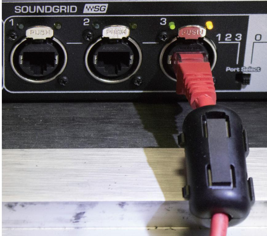
Para evitar interferencias, por favor, instale el filtro con pinzas en el cable Ethernet cerca a la unidad, como se muestra.
