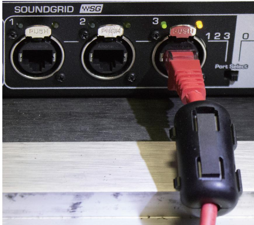
Para evitar interferência, instale o filtro acoplado ao cabo Ethernet próximo à unidade conforme mostrado.
