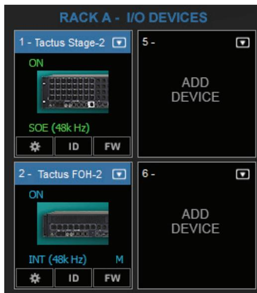
Tactus foh在LV1 系统配件屏幕上显示为两个独立设备，第一个设备是SGS（Sound-Grid服务器），在服务器部分进行分配。foh输入输出分配到某个输入输出基座，显示为Tactus foh。分配到哪个基座槽关系不大，但是用户可能希望将foh作为系统的主时钟，如上显示的INT（频率）和“M”，可在选择该设备的同一基座的下拉菜单中选择“设置主时钟”进行设置。Tactus Stage如上图所示通过以太网（SOE）接受时钟同步。
