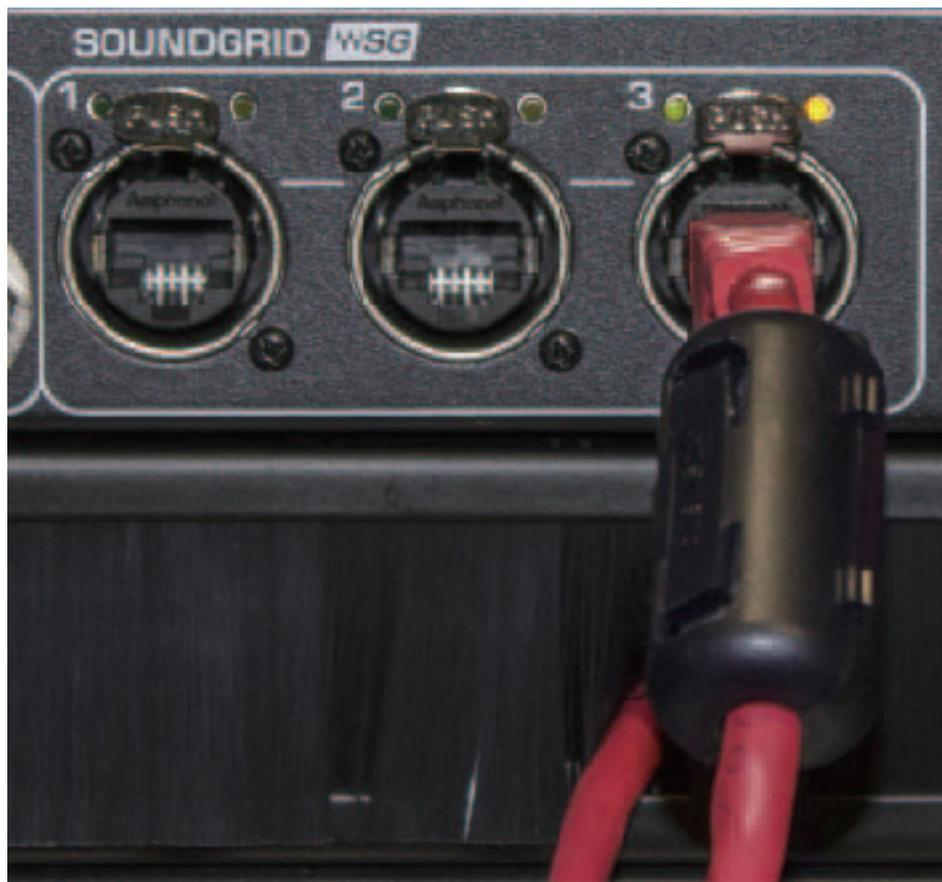
**!** 为了避免干扰，请在靠近设备一端的以太网电缆上安装卡箍式过滤器，如图所示。
