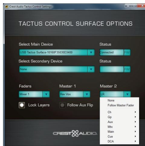
Quaisquer atenuadores no console podem ser atribuídos a esses atenuadores. Por exemplo, esses atenuadores podem ser usados para controlar subwoofers de alimentação auxiliar ou nível de reverberação.
