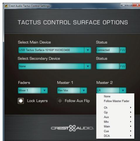
Tous les faders de la console peuvent être affectés à ces faders. Par exemple, ces faders peuvent être utilisés pour contrôler le niveau des caissons de basses ou des réverbérations alimentés par AUX.
